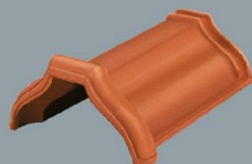
Gąsior nr 2 Waga: ok. 3,5 kg Zapotrzebowanie: 3,8 szt./mb Rozstaw w świetle: 19,5 cm Paleta: 60 szt.
