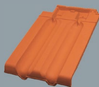
Dachówka dwufalowa Waga: ok. 4,4 kg Szer. krycia: 20,9 cm Dł. krycia: 36,4 - 38,4 cm Paleta: 88 szt.
