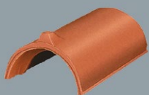
Gąsior nr 1 Waga: ok. 3,5 kg Zapotrzebowanie: 3,8 szt./mb Rozstaw w świetle: 18,5 cm Paleta: 54 szt.
