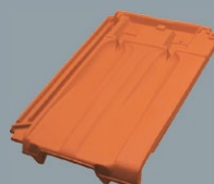
Dachówka wentylacyjna Waga: ok. 4,65 kg Przekrój wentylacyjny: ok. 25 cm 2 Paleta: 88 szt.
