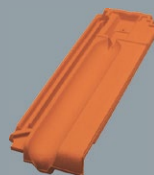
Dachówka połówkowa Waga: ok. 2,5 kg Szer. krycia: 11,8 cm Dł. krycia: 336,4 - 38,4 cm Paleta: 168 szt.
