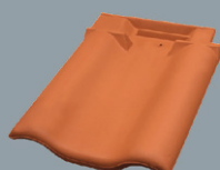
Dachówka dwufalowa Waga: ok. 4,5 kg Szer. krycia: 39 cm Dł. krycia: 37 – 39 cm Paleta: 55 szt.
