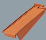
Dachówka szczytowa prawa 1/2 Waga: ok. 3,4 kg Zapotrzebowanie: 2,7 szt./mb Paleta: 100 szt.
