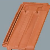
Dachówka wentylacyjna Waga: ok. 3,6 kg Przekrój wentylacyjny: ok. 20,0 cm 2 Paleta: 66 szt.
